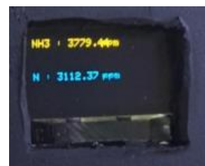
Gambar 10 Visualisasi pembacaan Sensor pada OLED
